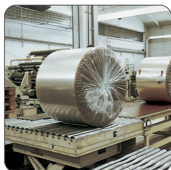
Válečkový dopravník se zvedacím stolem pro role papíru.
