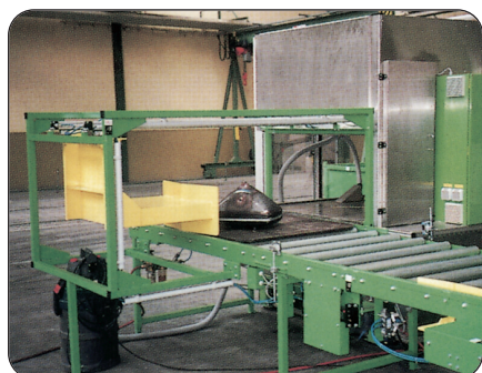
Doprava televizních přijímačů k demontáži a k odborné recyklaci televizních obrazovek.
