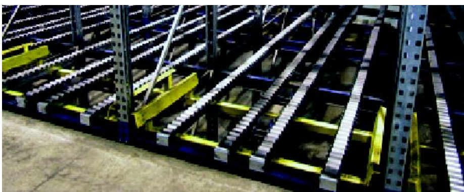
Těžké válečkové dráhy a průběžné regály pro dopravu palet podélně i příčně
