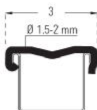
spona zabírající rozevření při zátěži SPS
