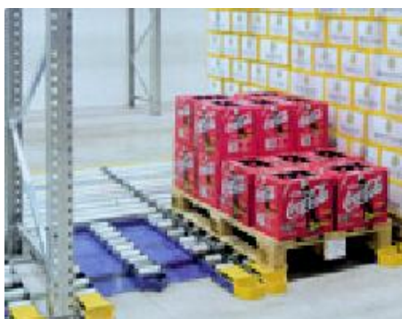
Těžké válečkové dráhy a průběžné regály pro dopravu palet podélně i příčně
